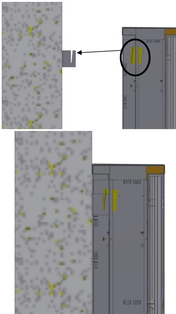
Afin d'éviter le décrochement, il est recommandé de sécuriser l'ensemble en le vissant contre le mur (orifices prévus dans toutes les alvéoles inférieures)
